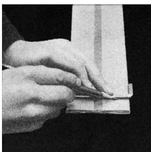
(1) ゲージピンを使って、ベルトの両端を直角に切る。この場合、ベルトの伸びを考慮して、ベルト全長の1/100だけ短く切っておく。
